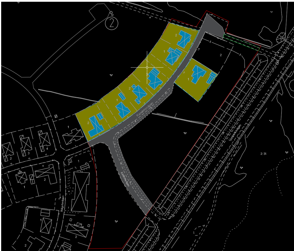
Figur 12 Ytor som avvattnas via befintlig dagvattenledning i punkt 2.
