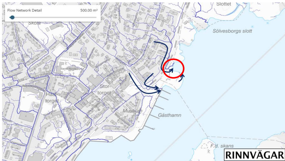
Figur 12 - Avrinningsstråken vid Havsudden som avvattnar bebyggelsen nordväst om Havsudden (Scalgo Live, u.d.). Blå streck indikerar stråk som avvattnar en area på minst 500 m 2 , röd cirkel visar rinnväg vid järnvägsspåret och de blå pilarna indikerar riktningen på rinnvägarna.
