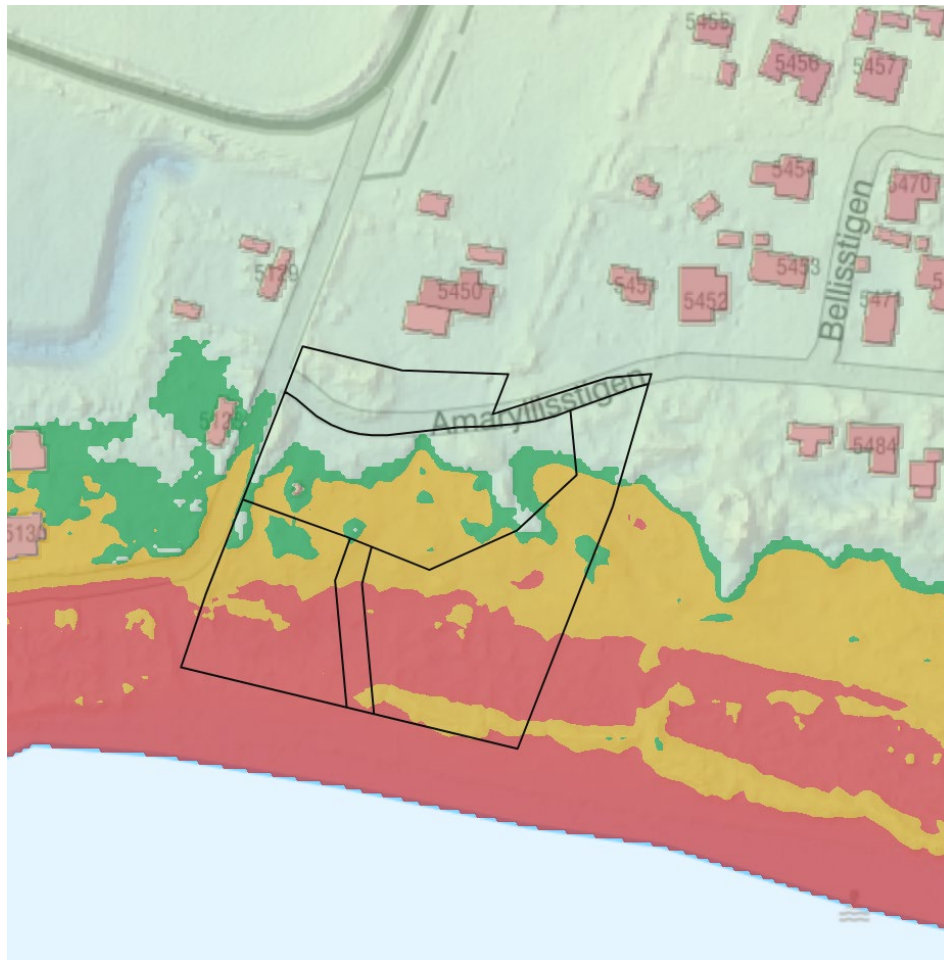
Figur 12. Översvämningsutbredning vid havsvattenstånd +2,5 m (RH2000). Gröna områden illustrerar vattendjup <0,3m, gula områden illustrerar vattendjup mellan 0,3–1,0 m och röda områden illustrerar vattendjup >1,0 m. Verktuget baseras på nationella höjddata - Markhöjdsmodell, grid 1+ (2023-07-24). Källa: Lantmäteriet hämtat från SCALGO Live (2023)
