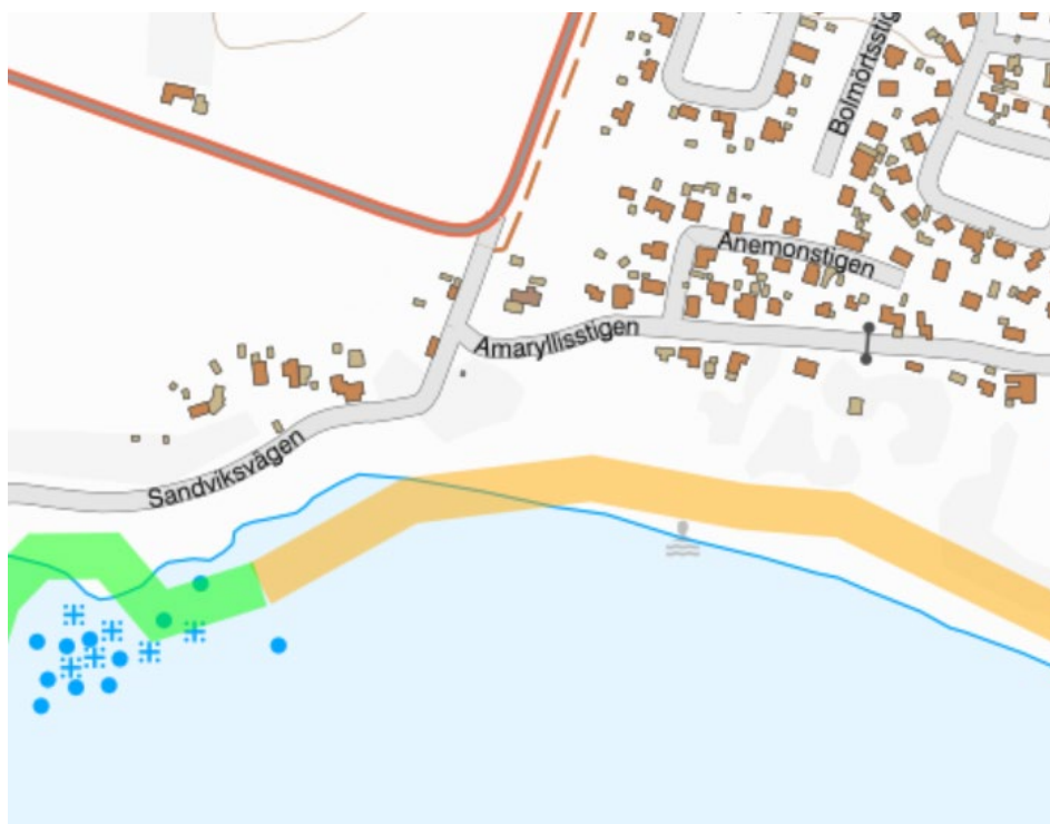
Figur 11. Erosionsförhållanden på stranden inom och i närheten av planområdet. Orange sträcka: Strand med växelvis erosion/ackumulation men i huvudsak balans. Grön sträcka: I huvudsak stabil strand; ingen eller obetydlig erosion.
