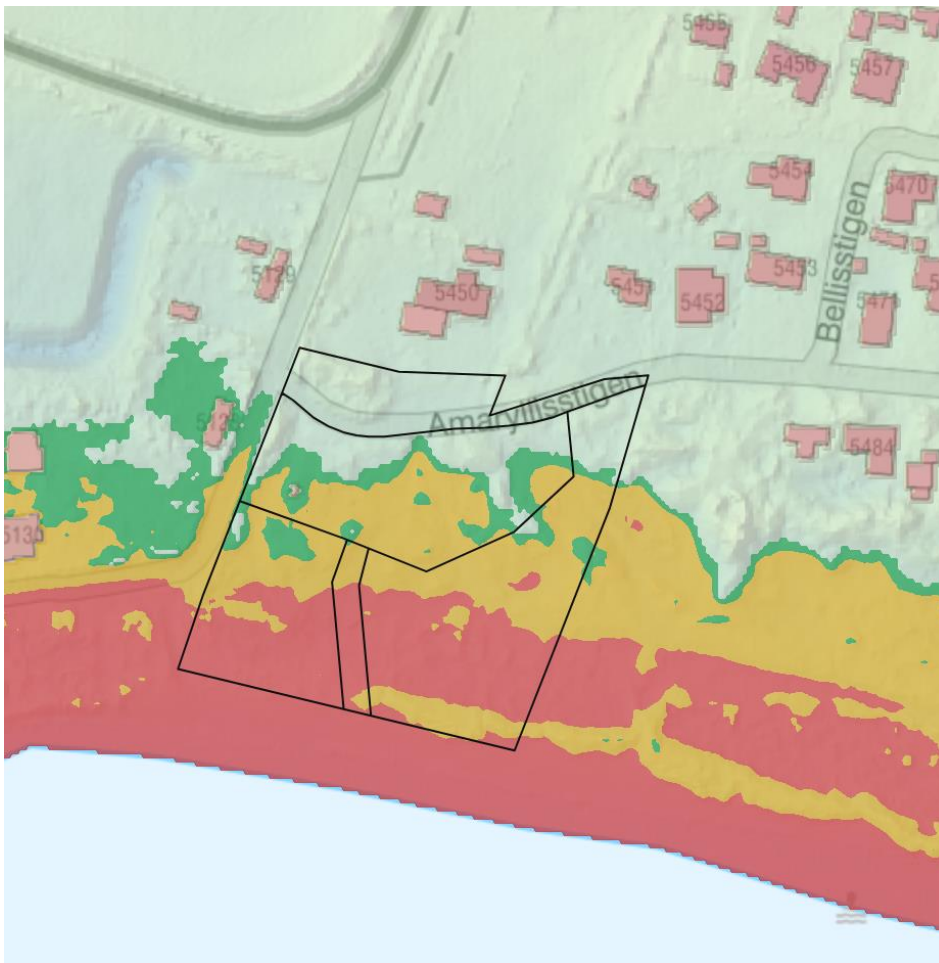
Figur 19. Översvämningsutbredning vid havsvattenstånd +2,5 m (RH2000). Gröna områden illustrerar vattendjup <0,3m, gula områden illustrerar vattendjup mellan 0,3–1,0 m och röda områden illustrerar vattendjup >1,0 m. Verktyget baseras på nationella höjddata - Markhöjdmodell, grid 1+ (2023-07-24). Källa: Lantmäteriet hämtat från SCALGO Live (2023)
