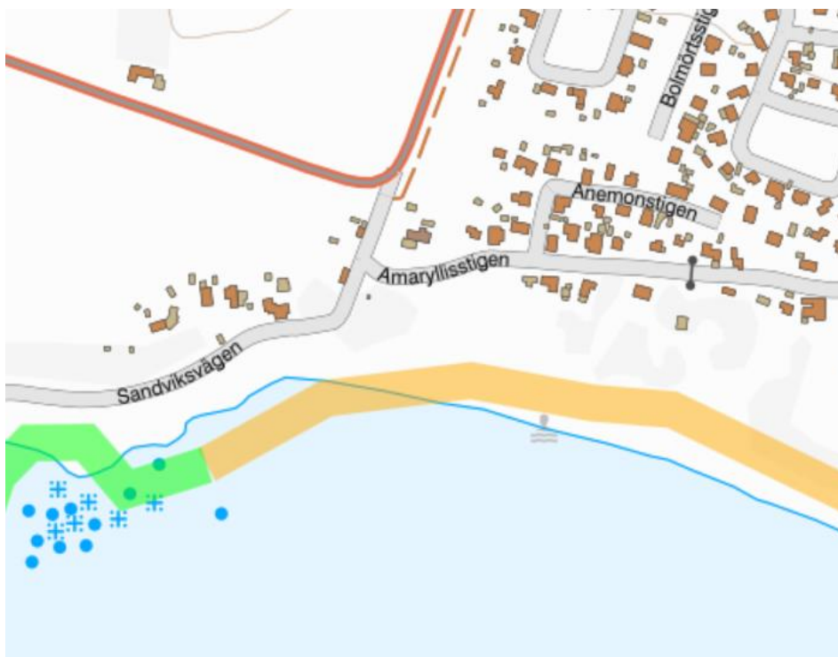
Figur 9. Erosionsförhållanden på stranden inom och i närheten av planområdet. Orange sträcka: Strand med växelvis erosion/ackumulation men i huvudsak balans. Grön sträcka: I huvudsak stabil strand; ingen eller obetydlig erosion.
