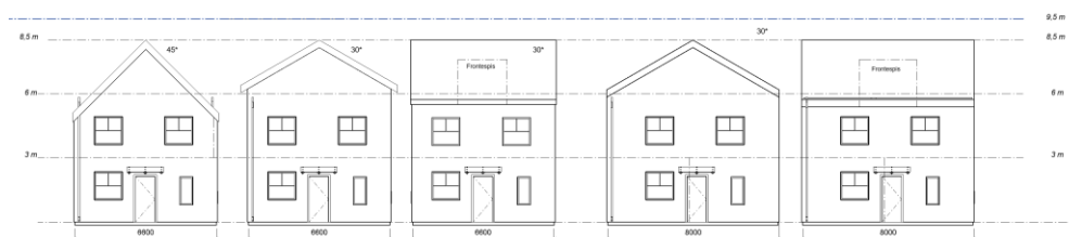
Illustration som visar möjlig utformning av smala radhus, kedjehus eller en del av parhus
